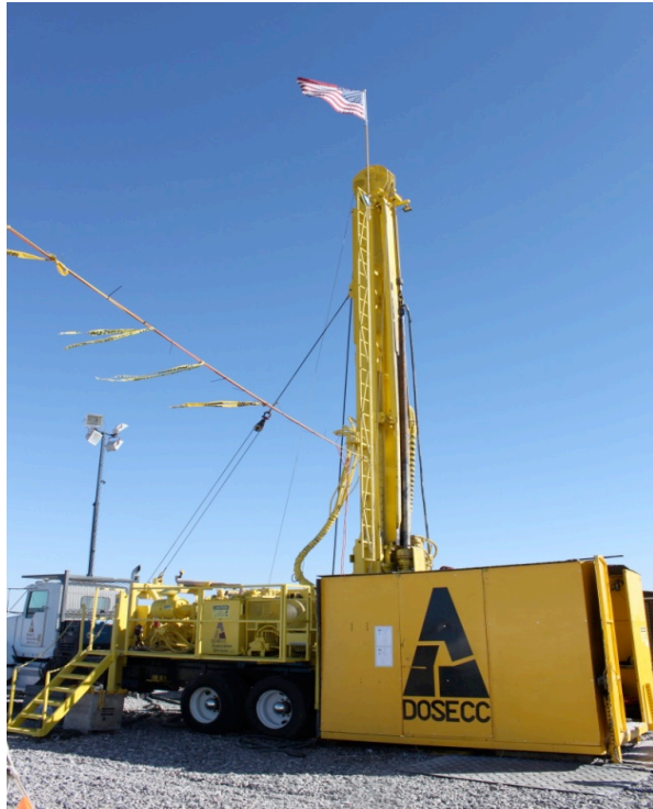
Figure 7-1. DOSECC CS-4002 core drill rig.
